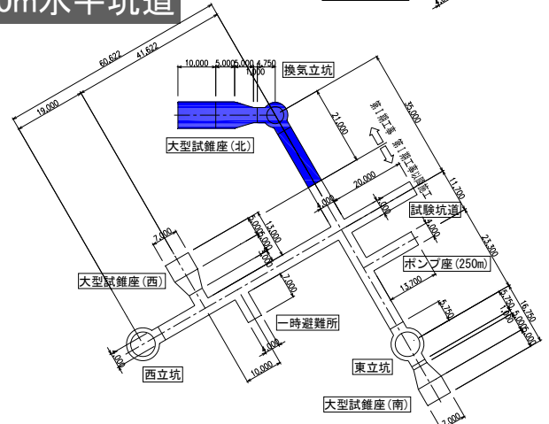
250m水平坑道
