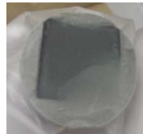
試料の解体 (試料寸法は3cm×3cm, 周囲がベントナイト)
