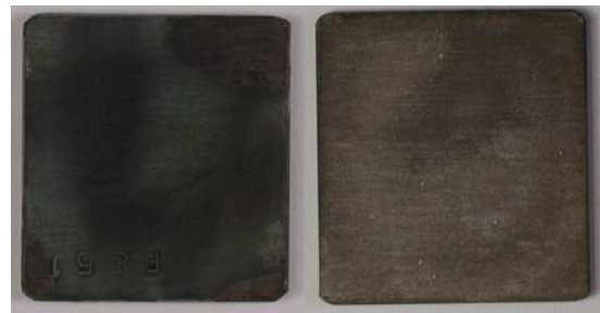
10年間の試験を行った後に炭素鋼 取り出した後の表面の状態
