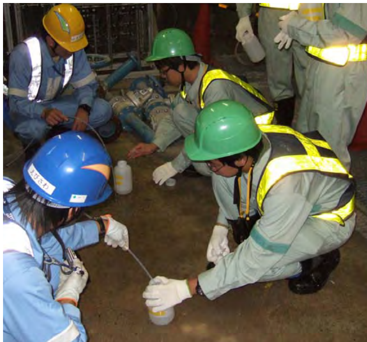
研究坑道内での地下水採水・化学分析
