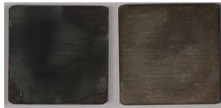
試料の解体 (試料寸法は3cm × 3cm. 周囲がベントナイト)
