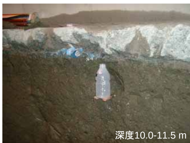
立坑壁面からの採水例(換気立坑)
