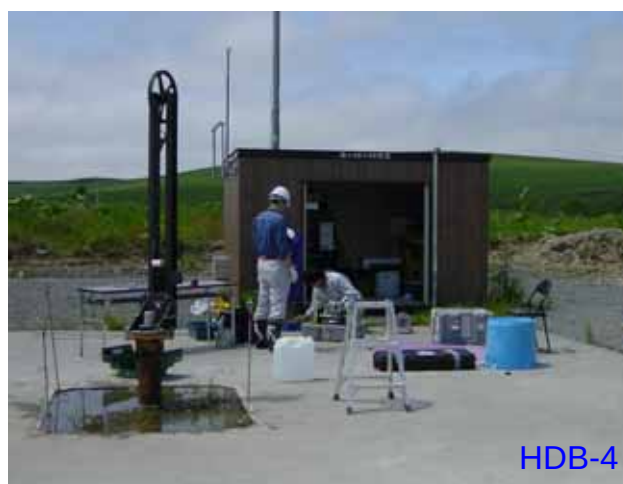
ボーリング孔からの採水例(HDB-4)
