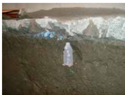
地下水の地球化学データ取得の例 (立坑壁面からの採水)
