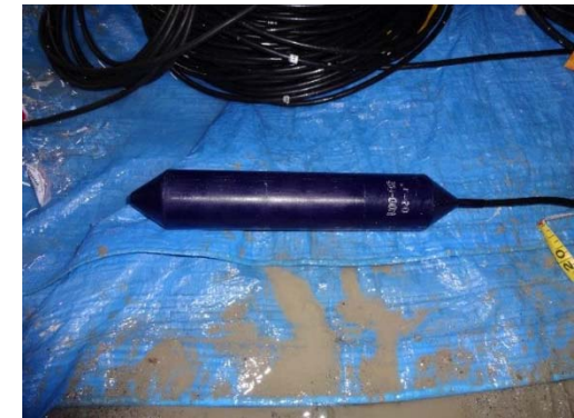
音響トモグラフィ震源 (周波数：52kHz, 78kHz, 104kHz)
