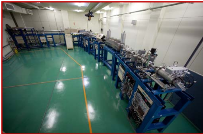
タンデム型加速器質量分析装置
