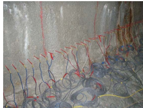
比抵抗二次元電極設置状況
