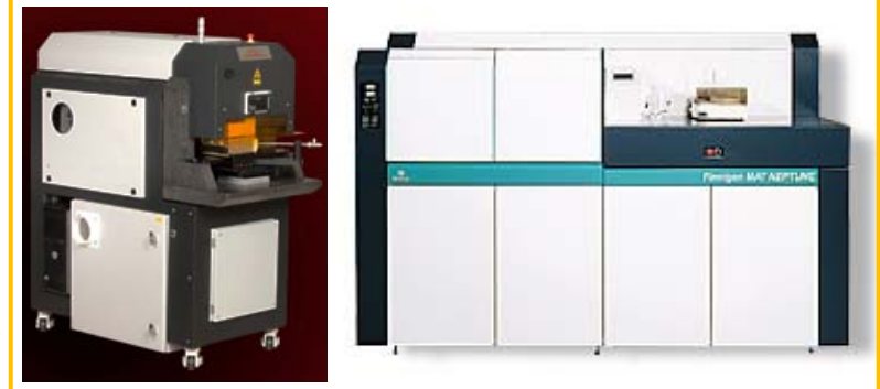
レーザーアブレーションシステム付き 誘導結合プラズマ質量分析装置 (ICP-MS)
