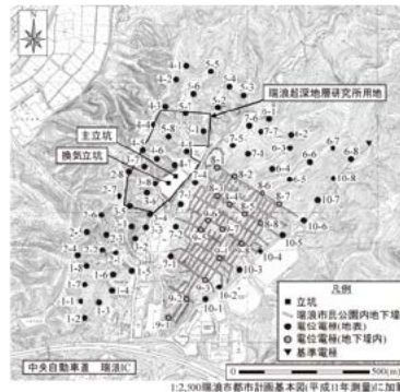
自然電位測定電極配置
