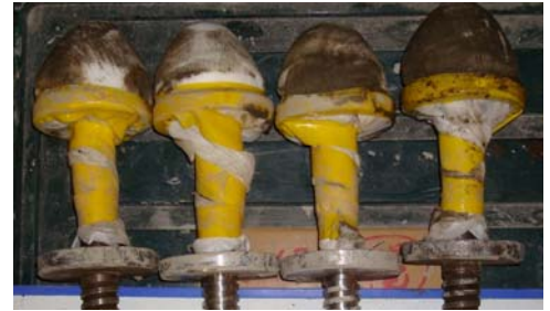
孔底掃除後の孔底面清掃器具の汚れ
