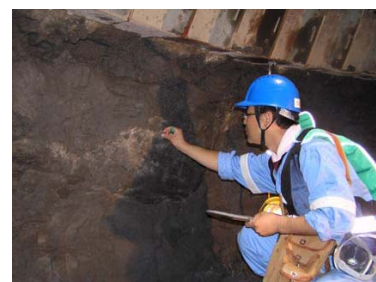
立坑壁面の地質観察状況
