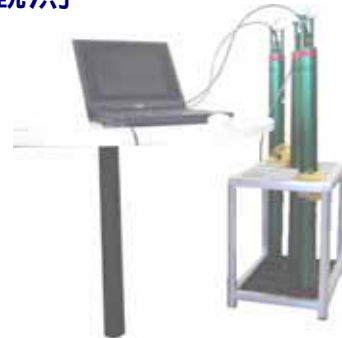
地下施設周辺に設置する高精度傾斜計
