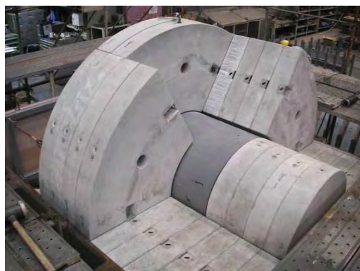
(a) ブロック方式の組立試験
