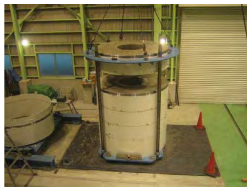
(b) 鋼殻リング方式の組立試験
