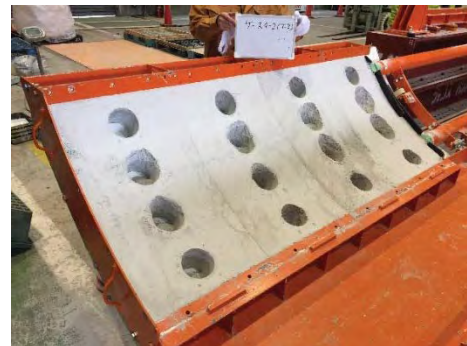
図 4.2.2.1-15 地上でのペレット充填試験後の乾燥密度の分布例 15)
