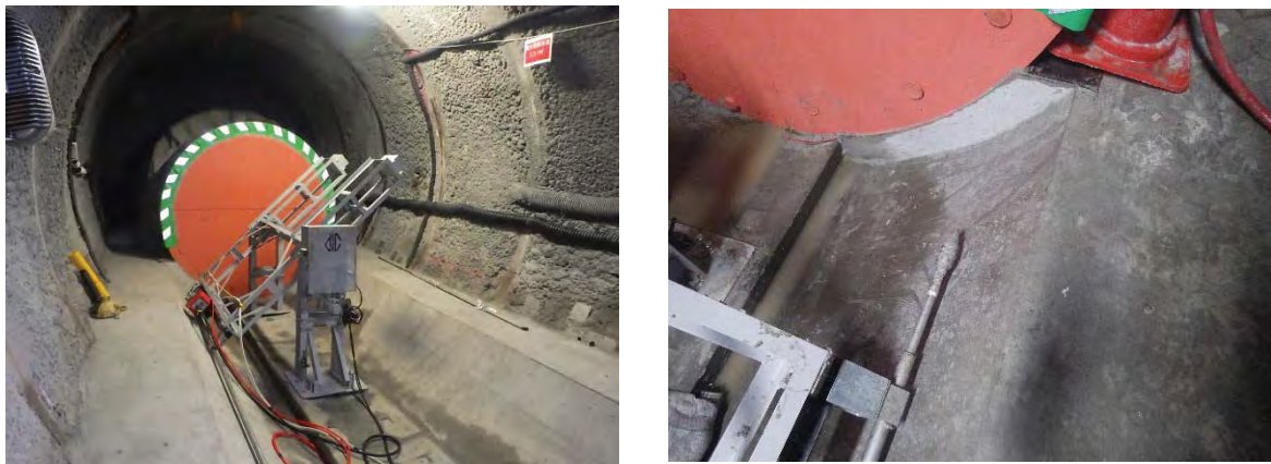
図 4.2.2.1-23 試験坑道 2 に設置したウォータージェット方式の除去装置
