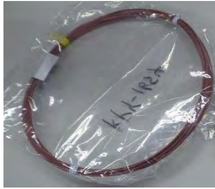
図 4.1.2.2-21 モールド型熱電対の外観写真
