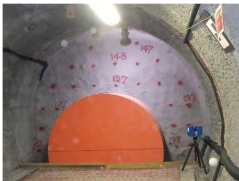
図 4.2.2.1-13 吹付け面からのサンプリング位置と乾燥密度分布の一例
