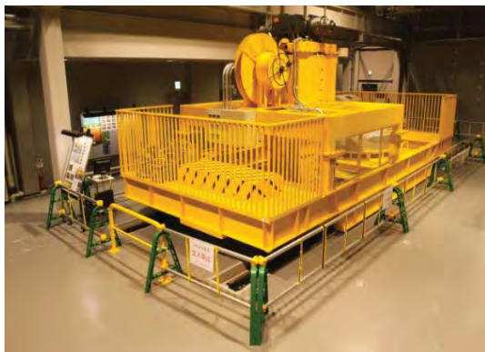
図 4.2.2.1-1 処分孔竖置き・ブロック方式を対象とした緩衝材定置技術の整備状況 8)
