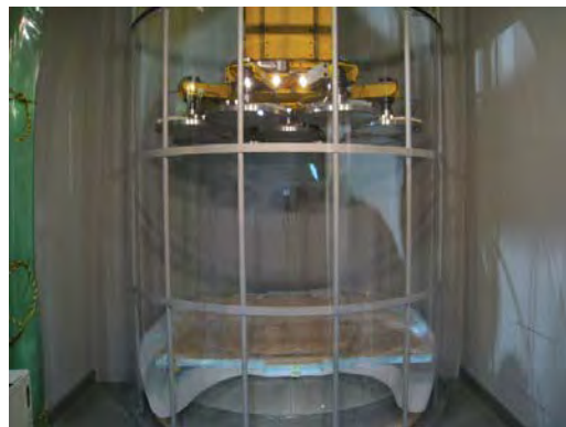
図 4.2.2.1-1 処分孔竖置き・ブロック方式を対象とした緩衝材定置技術の整備状況 8)
