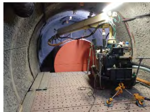
図 4.2.2.1-12 試験坑道 2 における伸縮アーム装置による吹付け試験の様子
