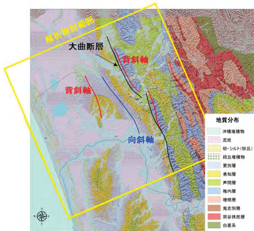
図 1.4-11 地表で確認される地質構造（酒井・松岡, 2015 11) に加筆）
