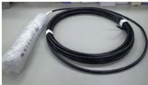
図 4.1.2.2-16 亜鉛照合電極の外観写真
