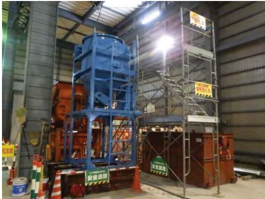
図 4.2.2.1-11 西立坑地上建屋における充填材料（ベントナイト混合土）の製造
