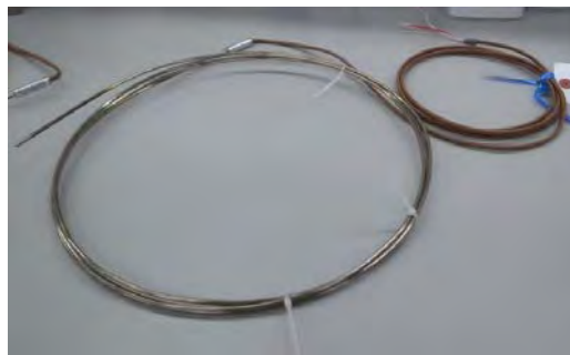
図 4.1.2.2-20 シース型熱電対の外観写真
