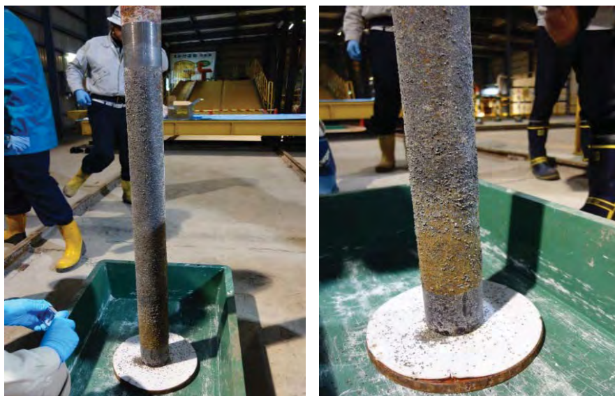
図 4.1.2.1-3 緩衝材除去後の模擬オーバーパック外観
