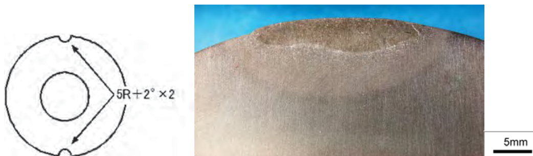
図 4.1.2.2-1 模擬オーバーパックに付与した溶接部の開先形状および断面マクロ組織
