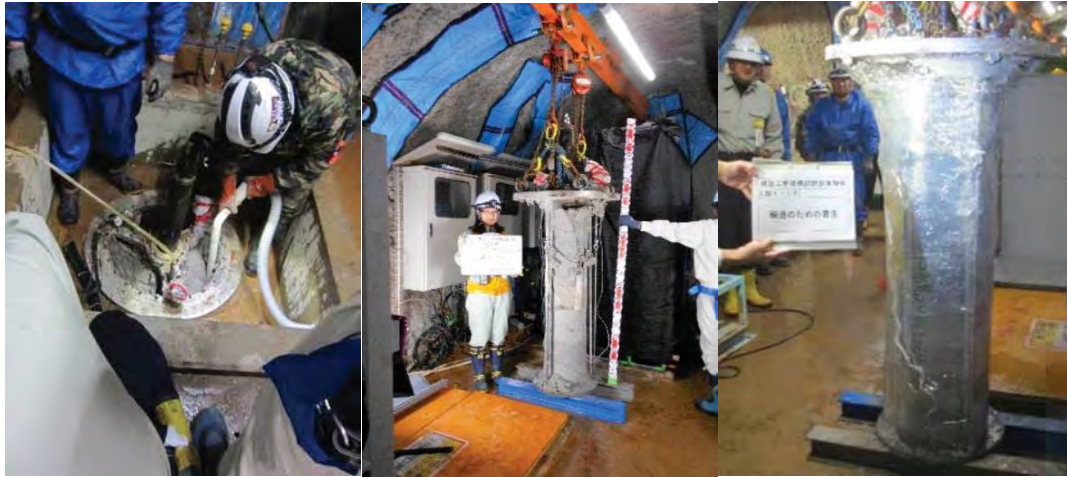
図 4.1.2.2-6 試験孔からの試験装置の取り出し状況
