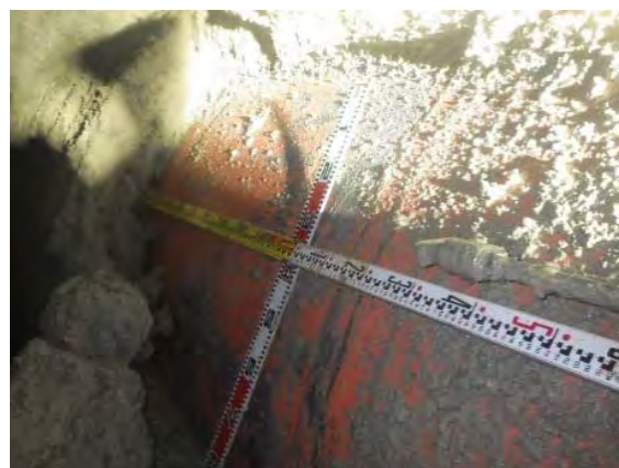
図 4.2.2.1-25 上部開放部の模擬 PEM 近傍の充填材に対するトルネードノズルの効果
