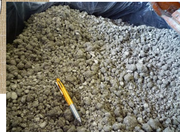
掘削土(ズリ)を用いた埋め戻し材
