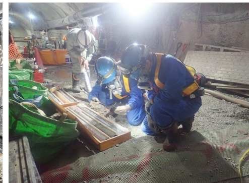
ボーリングコアの確認
