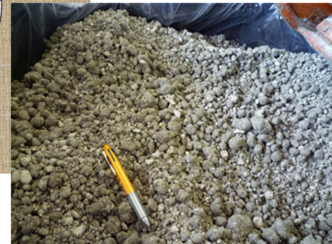
掘削土(ズリ)を用いた埋め戻し材
