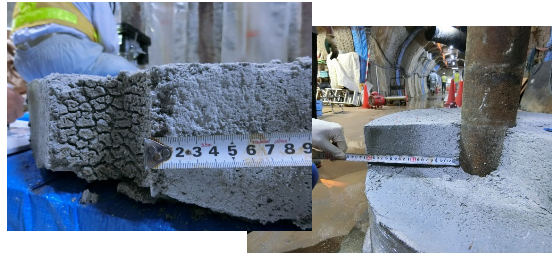
ヒーター接触部に認められた緩衝材のひび割れ(左)、 緩衝材内部の色調分布の変化(右)
