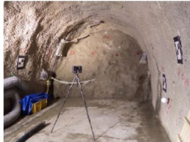
埋め戻し試験の様子(右は3Dスキャナーによる出来型計測)
