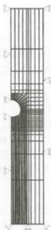
図 4.2.2- 40 解析モデル (軟岩、主要・連絡坑道)
