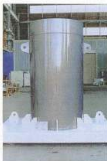
図 4.1.1-24 炭素鋼オーバーバックの試作例 (本田ほか, 1992)
