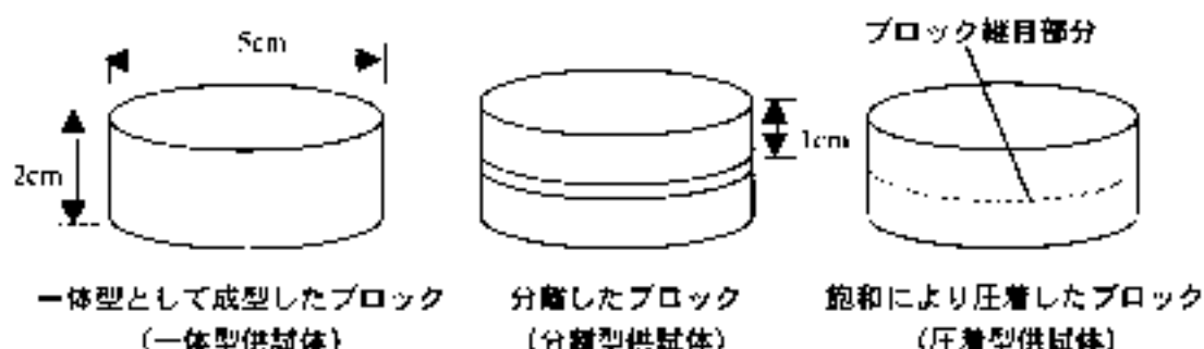
図 4.1.2- 62 ブロック継目部のせん断特性に関する試験供試体の模式図
