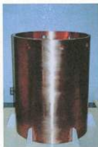
図 4.1.4-2 試作した銅製外容器の外観 容器の高さは実規模の約1/2（他はフルスケール）
