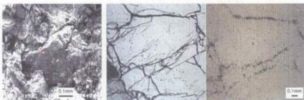
a: 鉱物粒子中の微小割れ目
