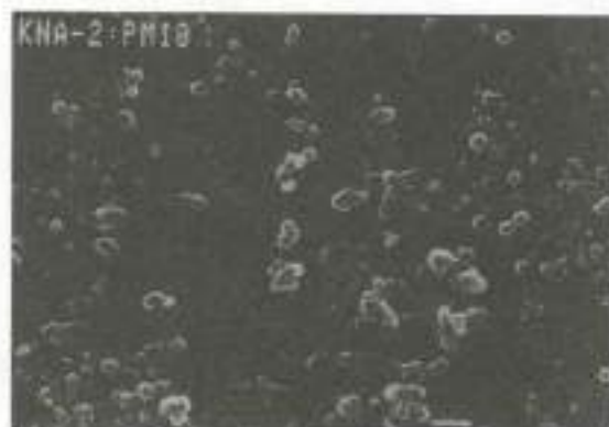
図 3.4-13 東濃地域の堆積岩中の地下水から回収されたコロイド粒子
