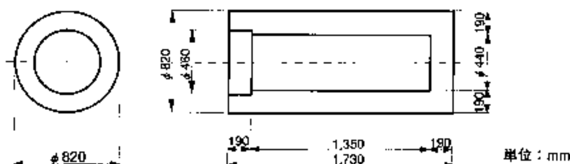
図 4.3-11 炭素鋼オーバーバックの仕様例
