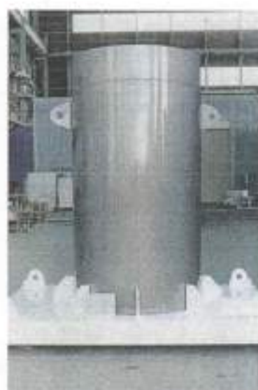
図 4.3-10 炭素鋼オーバーパックの試作例（本田ほか，1992）
