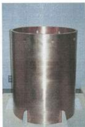
図 4.3-13 試作した銅製外容器の外観 容器の高さは実規模の約 1/2（他はフルスケール）
