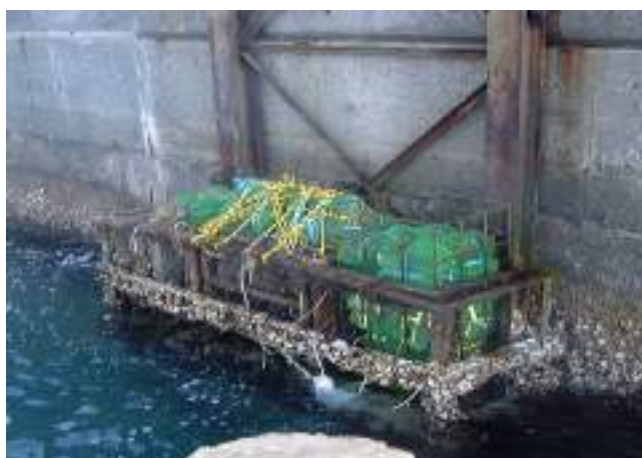
図 4.2-5 鉄筋を埋設したコンクリート供試体の海上飛沫帯での暴露状況
