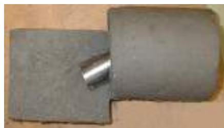
図 3.3.2-7 緩衝材中の模擬オーバーパックスの回転状況（試験 1）
