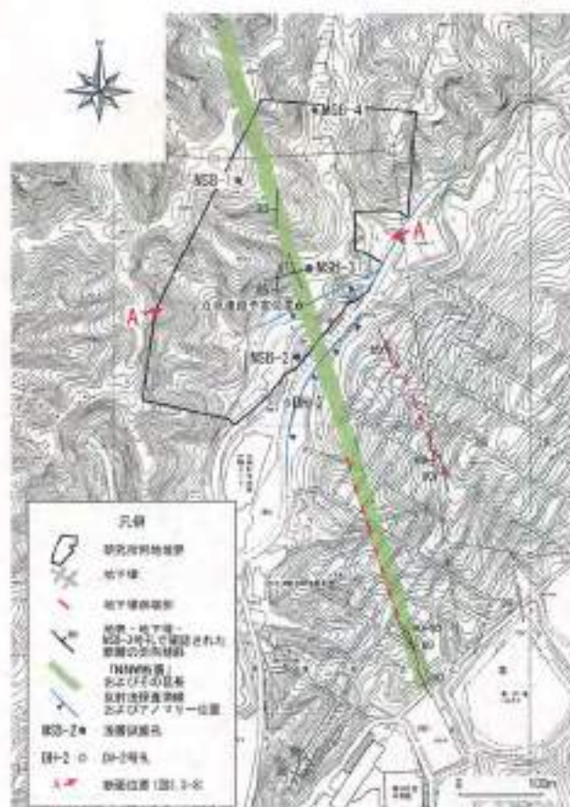
図 3.3-7 調査結果を基に推定した研究所用地を縦断する「NNW 断層」の分布
