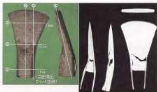
図 4.2-44 出土斧の写真と X 線 CT 画像 (右側写真で、大部分の残存鉄部分は白色、周囲の錆部分はわずかに灰色となっている。)
