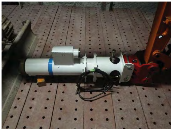
図 4.2.2.1-19 オーガー方式の隙間充填材の除去装置
