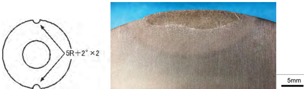
図 4.1.2.2-1 模擬オーバーパックスに付与した溶接部の開先形状および断面マクロ組織
