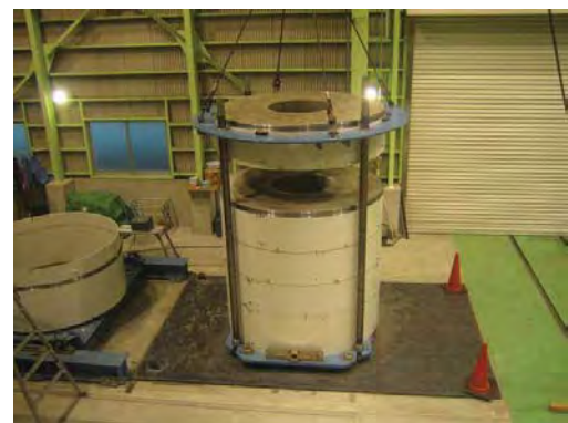
(b) 鋼殻リング方式の組立試験
