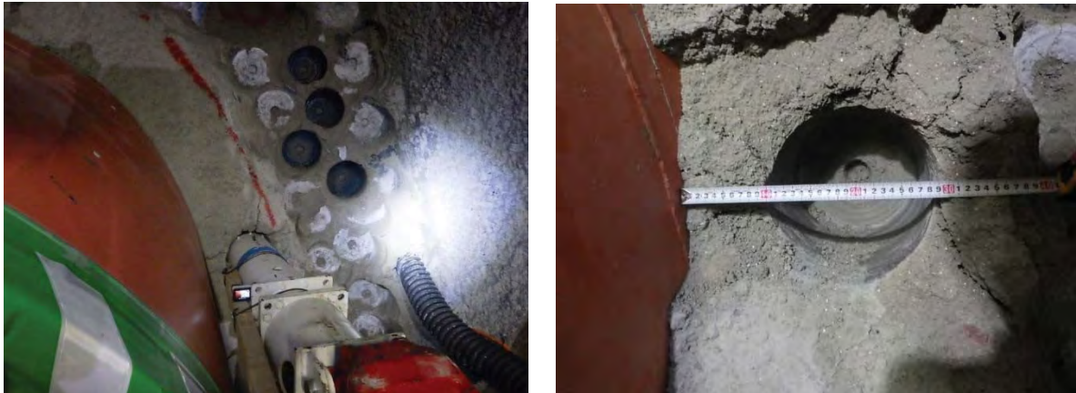
図 4.2.2.1-22 模擬 PEM 近傍までのオーガー方式による切削可否の確認
