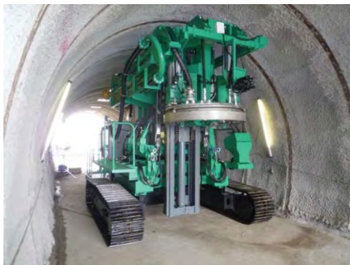
図 4.2.2.1-2 処分孔竖置き方式を対象とした緩衝材除去技術の整備状況 7)
