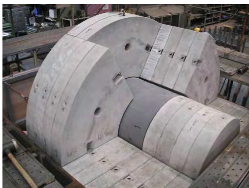
(a) ブロック方式の組立試験
