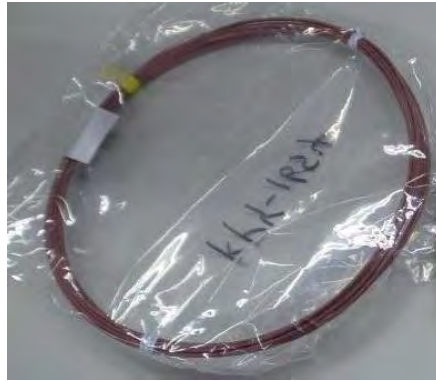
図 4.1.2.2-21 モールド型熱電対の外観写真
