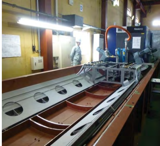
図 4.2.2.1-26 エアベアリング方式の PEM の定置・回収装置（実機）
