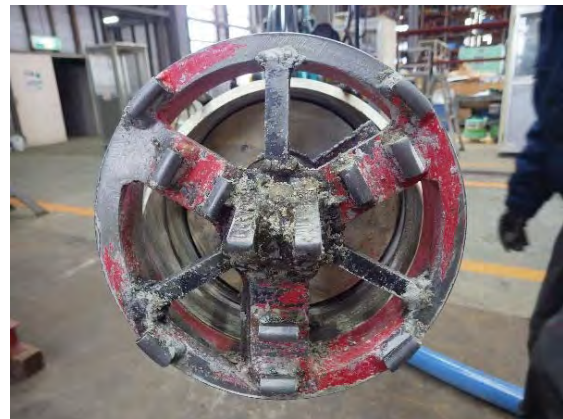
図 4.2.2.1-19 オーガー方式の隙間充填材の除去装置
