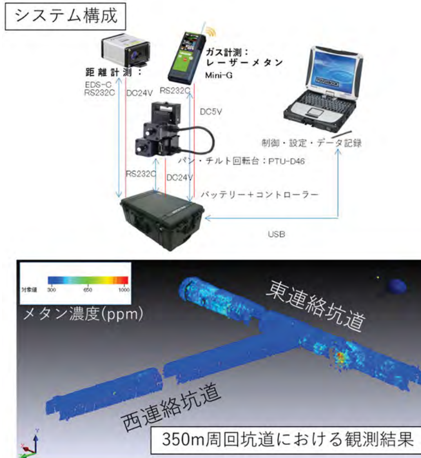
図 1.3-6 新しく開発した計測装置のシステム構成（上）と計測例（下）
