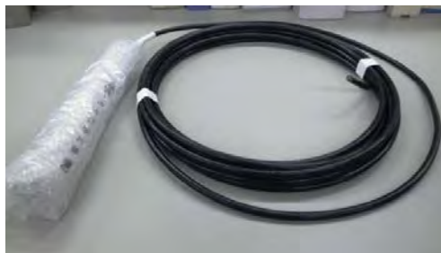
図 4.1.2.2-16 亜鉛照合電極の外観写真
