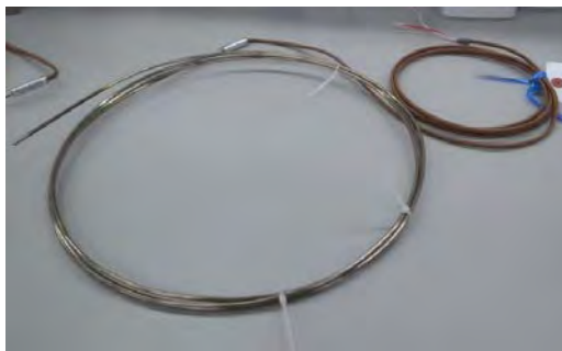
図 4.1.2.2-20 シース型熱電対の外観写真
