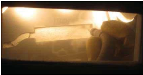
(a) サンドブラストによる溝の構築
