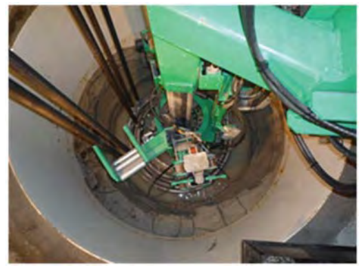
図 4.2.2.1-2 処分孔竖置き方式を対象とした緩衝材除去技術の整備状況 7)
