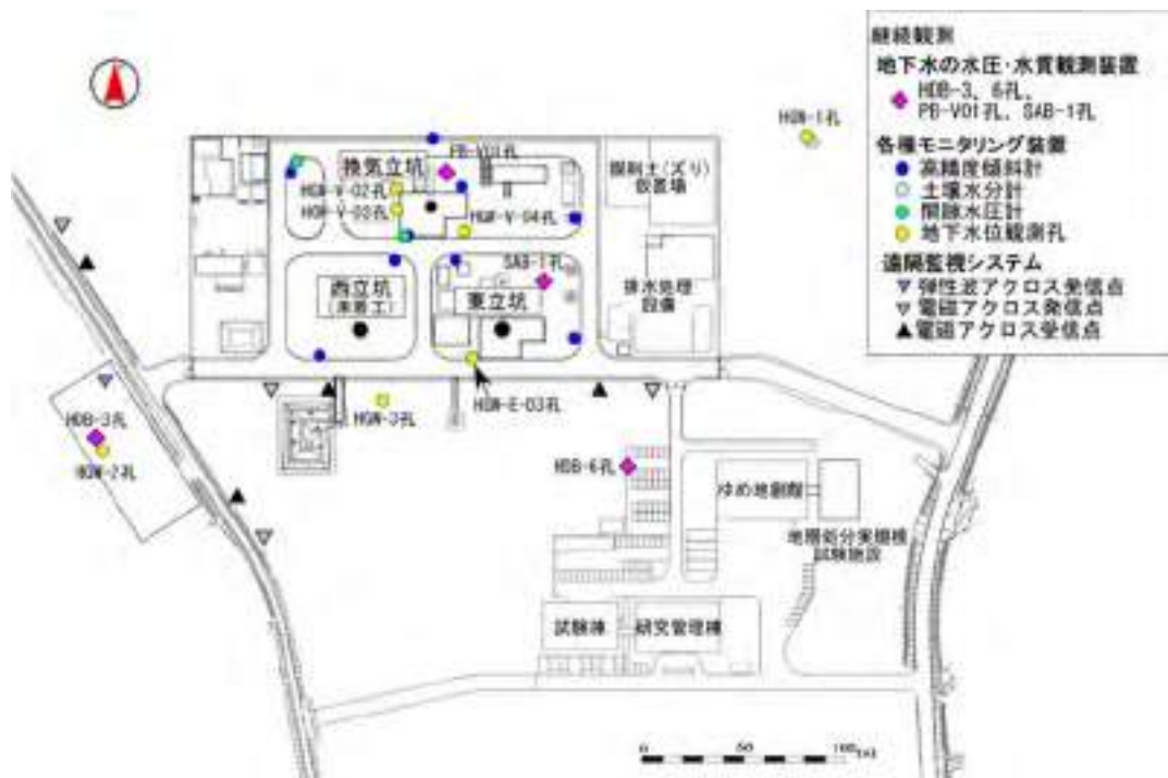
図 2.1.2-3 研究所用地周辺における地下水位観測用の浅層ボーリング孔の位置
