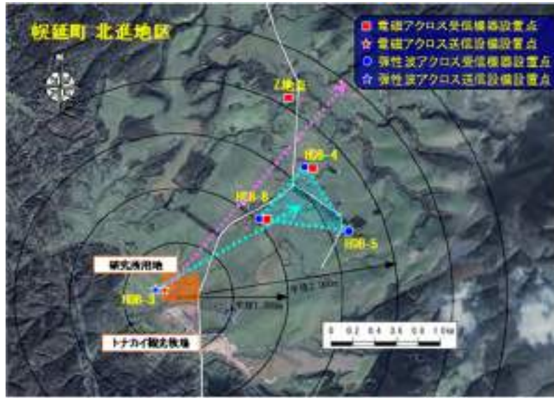
図 2.3.1-17 遠隔監視システムの観測機器の配置
