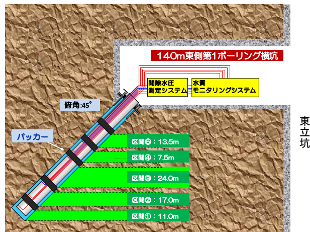
図 2.3.2-6 地下水の間隙水圧・水質モニタリング装置の概要(深度 140m 調査坑道)
