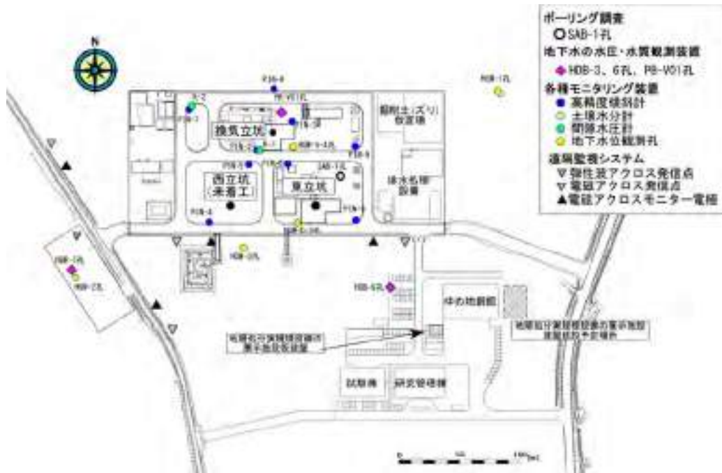
図 2.3.1-20 研究所用地における主な施設と観測装置の配置
