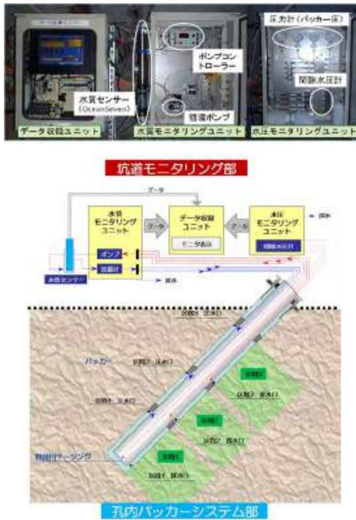
図 2.3.2-10 間隙水圧・水質モニタリング装置の概要（深度 350m 調査坑道）
