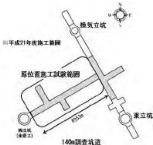
図 5.1.1-7 HFSC を用いた吹付けコンクリート 図 5.1.1-8 原位置施工試験実施状況 の原位置施工試験範囲（深度 140m 調査坑道）
