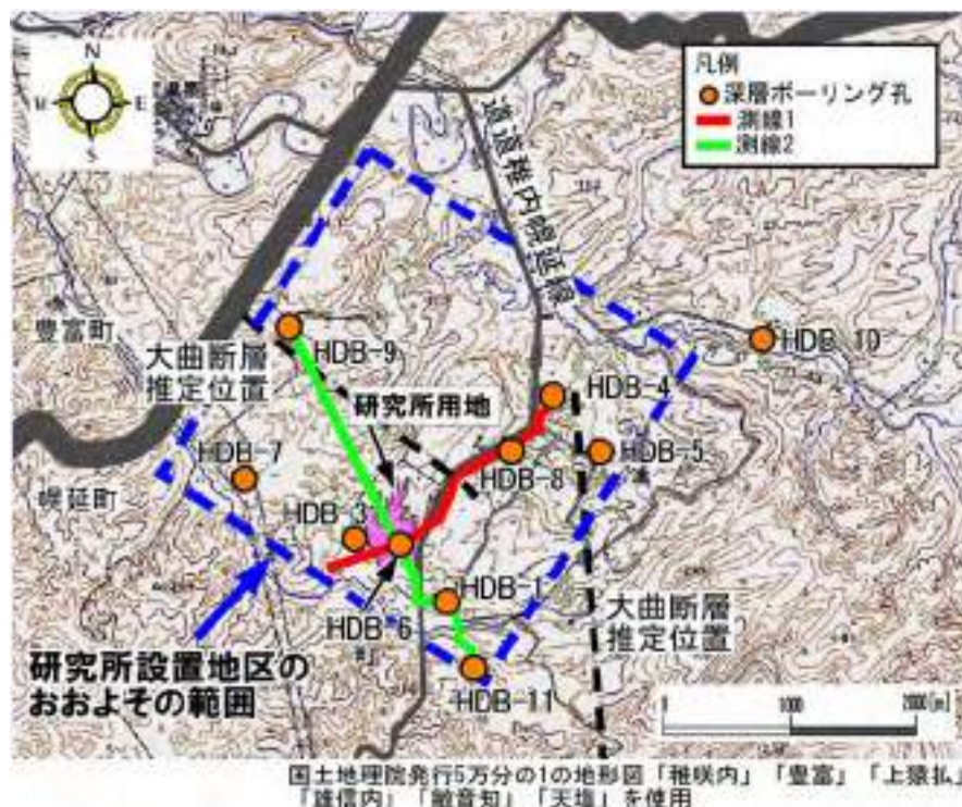
図 2.3.1-9 電気探査の測線配置
