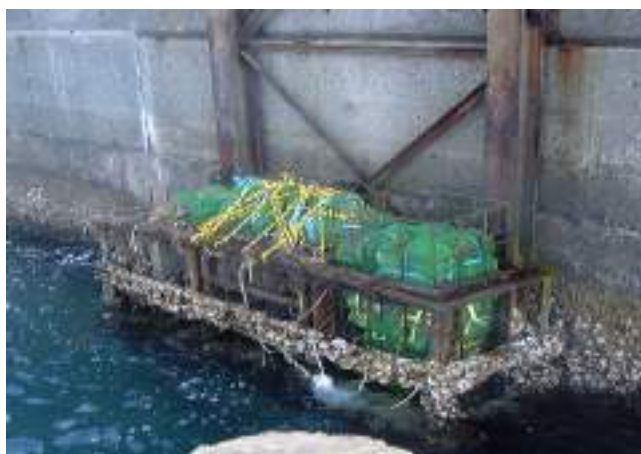
図 2.2.6-7 鉄筋を埋設したコンクリート供試体の海上飛沫帯での暴露状況
