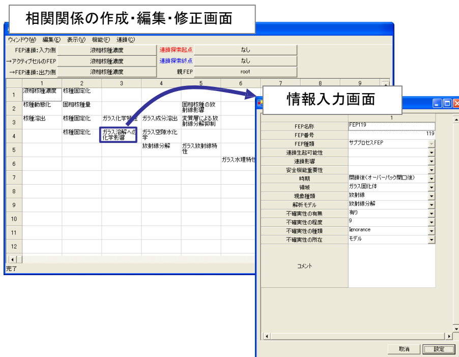
図3 マトリクスの設定・編集および各マトリクスに入力した FEP のプロパティ情報の設定・編集の機能 (各層のマトリクスの新規作成は、画面上の空白のセルからなるスプレッドシートに対角要素および非対角要素を設定することを繰り返すことで実施します)
