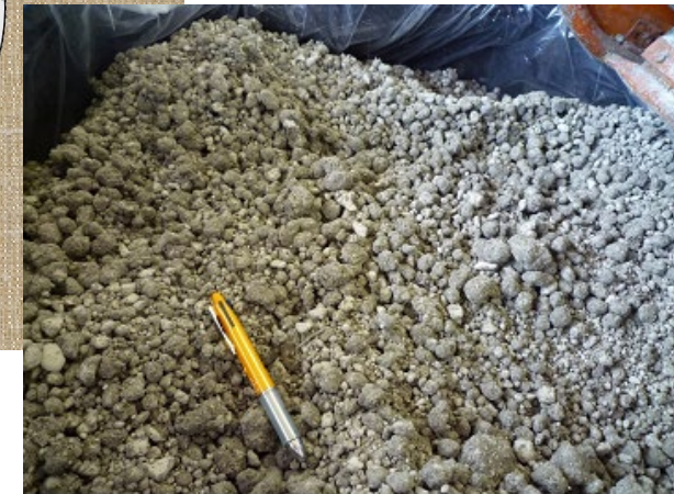
掘削土(ズリ)を用いた埋め戻し材
