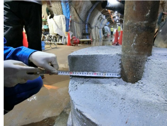
緩衝材内部の色調の変化(左)、色調変化の範囲の計測結果(右)
