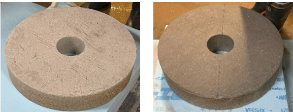
初期含水比10.5%(左)および15.0%(右)で作製した緩衝材ブロック
