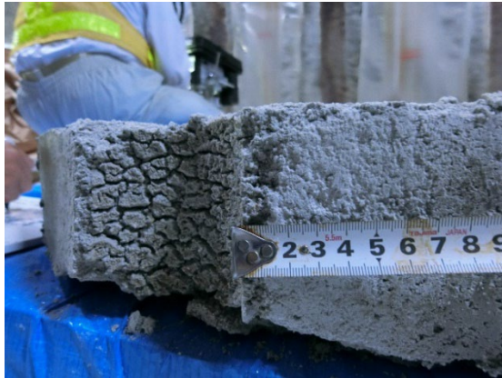
ヒーター接触部に認められた緩衝材のひび割れ
