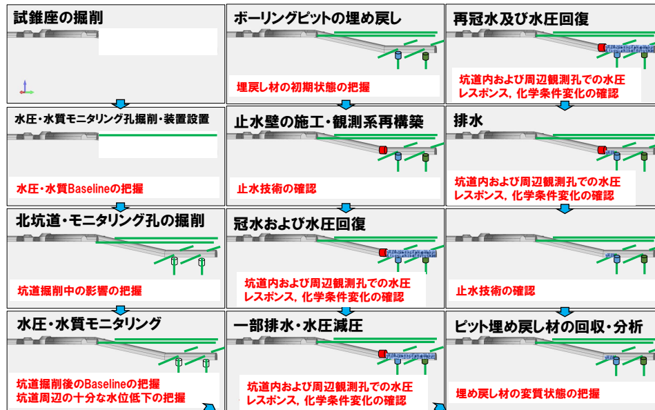
再冠水試験の流れ
