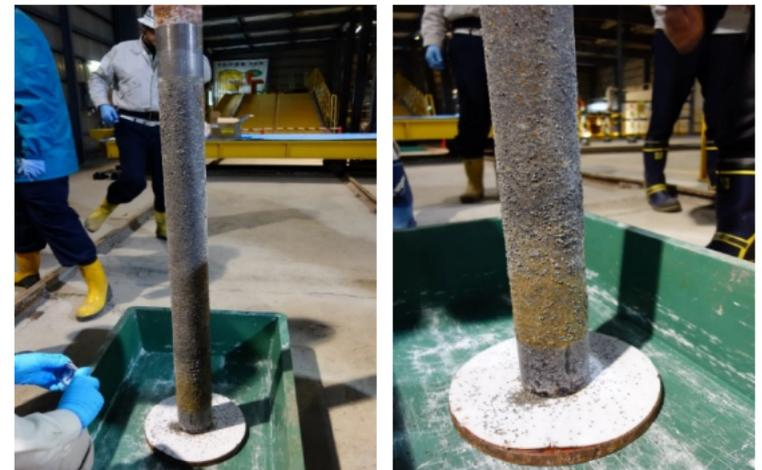
オーバーパック腐食試験後の試験体取り出し
