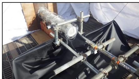
切削試験の様子(φ100mm,L1m) ノズルの動きを検証するための試験装置 (計画イメージ)
