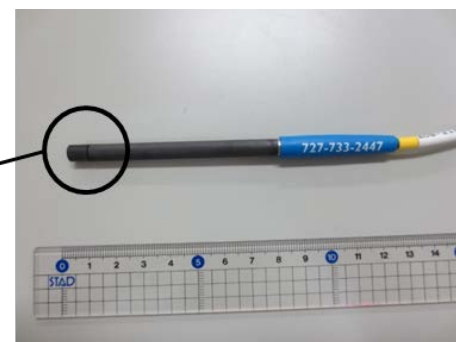
光学式pH計のセンサー部の構造(左)とpH計の外観(右)
