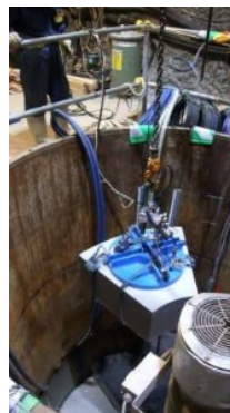
緩衝材ブロックの製作と試験孔への定置の例
