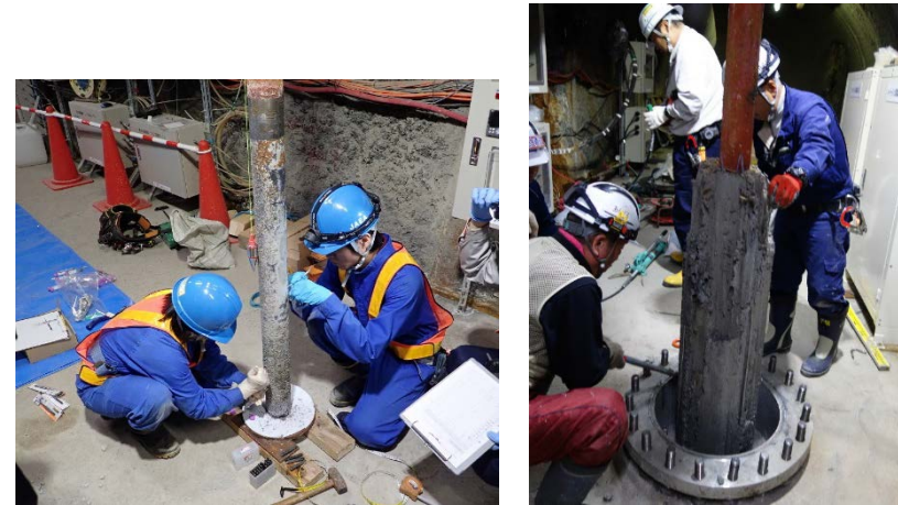
試験体の取り出し状況(左)と 模擬オーバーバック表面の試料採取状況
