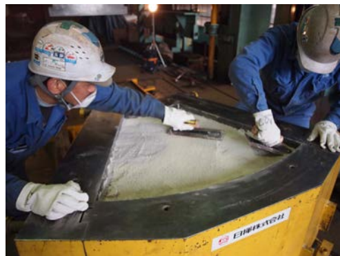
緩衝材ブロックの製作と試験孔への定置の例
