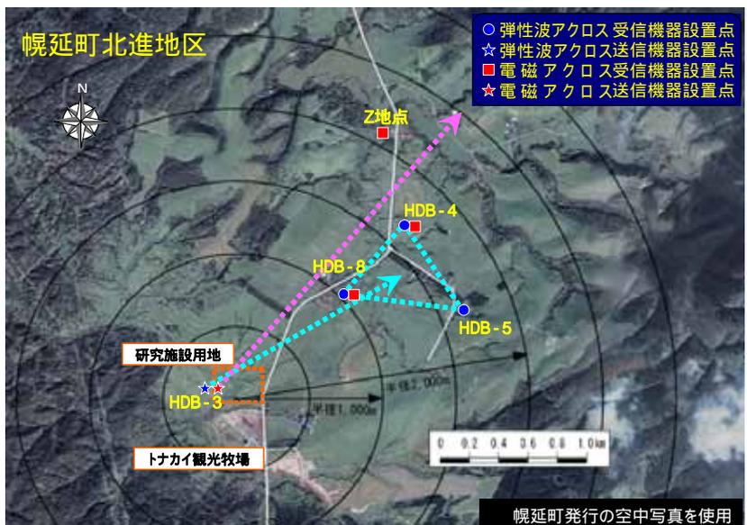
遠隔監視システムの観測機器配置図
