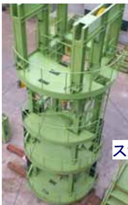
スカフォードを用いた立坑の機械掘削方式イメージ
