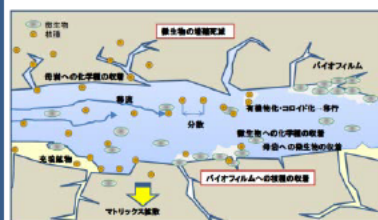
地質環境中での物質の移動現象に及ぼす微生物影響の概念図
