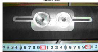
並列型ポート部(拡大) パッカー—体型トレーサ投入装置
