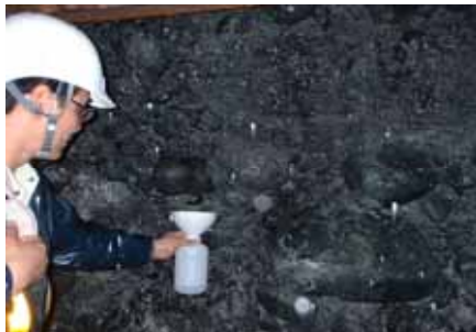
瑞浪超深地層研究所の例 地下水の地球化学データ取得の例 (立坑壁面からの湧水の採取)
