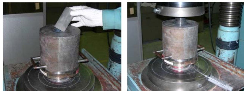
高圧抽出装置によるセメント硬化体からの間隙水の採取状況(左図:硬化体のセッティング, 右図:載荷及び間隙水の採取)
