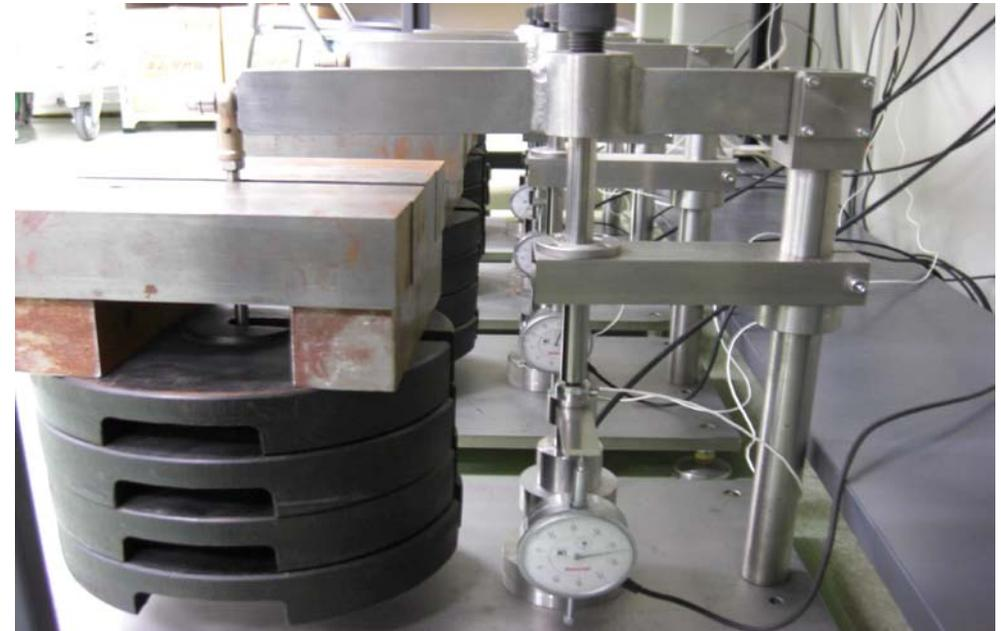
体積膨潤ひずみ試験装置の概観
