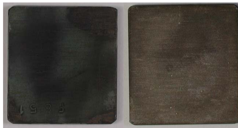
10年間の試験を行った後に炭素鋼 取り出した後の表面の状態
