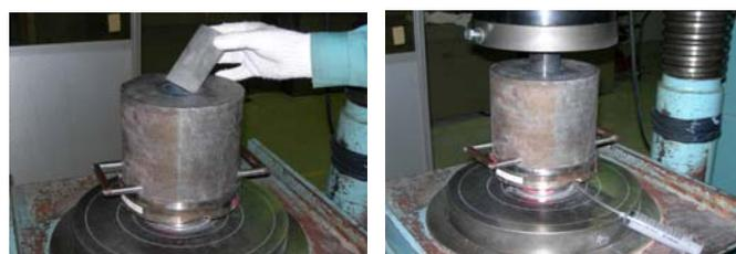
高圧抽出装置によるセメント硬化体からの間隙水の採取状況 (左図:硬化体のセッティング, 右図: 載荷及び間隙水の採取)
