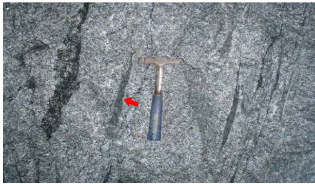
①：高角度割れ目に充填したグラウト材
