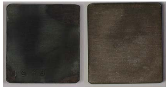
10年間の試験を行った後に炭素鋼 取り出した後の表面の状態 左:80°C 海水 クニゲルV1 1.8\text{g/cm}^3 右:50°C 海水 クニゲルV1 1.8\text{g/cm}^3 11
