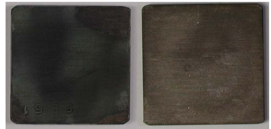
10年間の試験を行った後に炭素鋼 取り出した後の表面の状態 左: 80°C 海水 クニゲルV1 1.8\text{g/cm}^3 右: 50°C 海水 クニゲルV1 1.8\text{g/cm}^3
