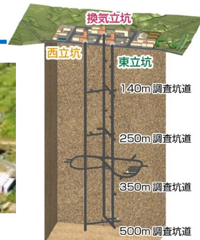
(イメージ図) 深度500mの調査坑道の掘削が完了 (R7.9.4)
