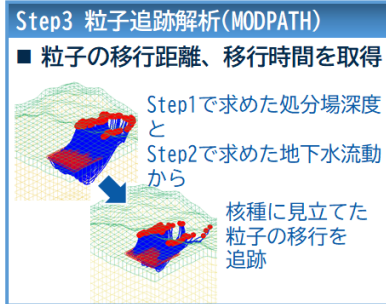
図1 隆起・侵食による地形・処分場深度の変遷が地下水流動を介して核種移行(粒子の移行)に与える影響の評価手法
