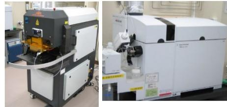
微量元素分析に使用したレーザーアブレーション(LA)装置(左)とICP質量分析装置(右)
