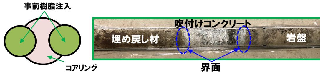
埋め戻し材、吹付けコンクリート、岩盤界面サンプリング後の試料
