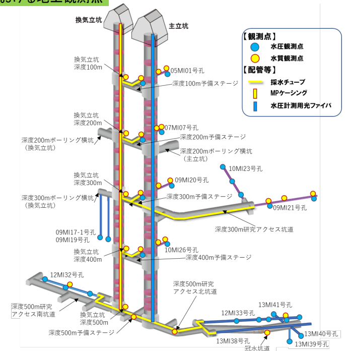
地下水の環境モニタリング調査における地下観測点
