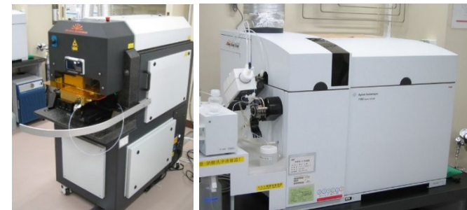
土岐地球年代学研究所でのテフラの微量元素分析に使用したレーザーアブレーション(LA)装置(左)とICP質量分析装置(右)
