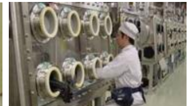
還元環境を模擬したグローブボックス内における放射性物質移行データの取得
