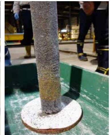
オーバーパック腐食試験後の試験体取り出し
