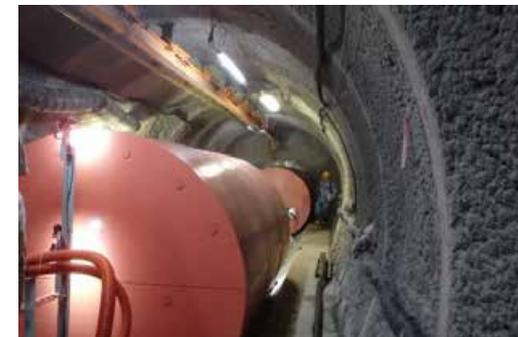
模擬PEMの回収試験状況
