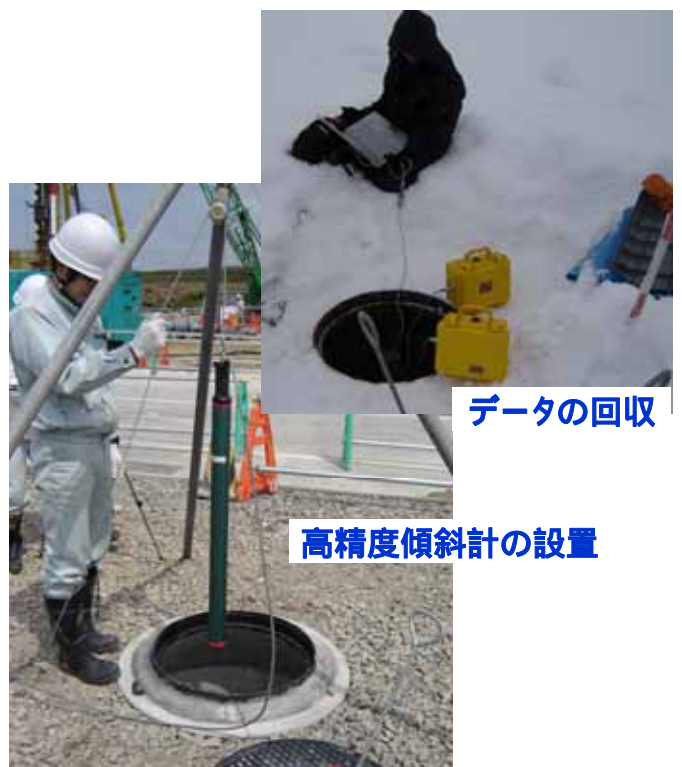
高精度傾斜計の設置・データ収集
