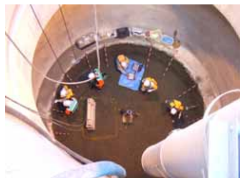
立坑壁面観測・計測状況
