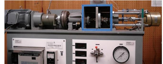
回転剪断式高速摩擦試験機
