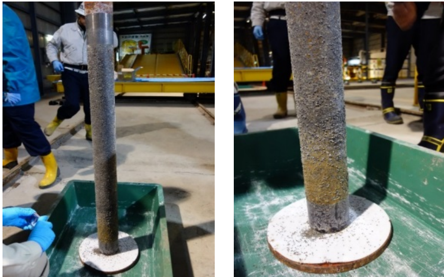
図3 緩衝材除去後の模擬オーバーパック外観
